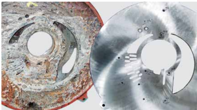
Elmo-ohjauskiekkojen (uuden ja vanhan) vertailu. Toiminnan kannalta ratkaiseva tiivistyspinta on voimakkaasti syöplynyt, ohjauslovet ovat tukossa: seurauksena on valtava energiahäviö.
