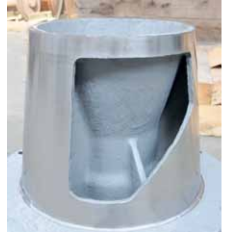
Käyttöolosuhteiden mukaan valituilla suojakomposiiteilla pinnoitetut sivupäädät.
