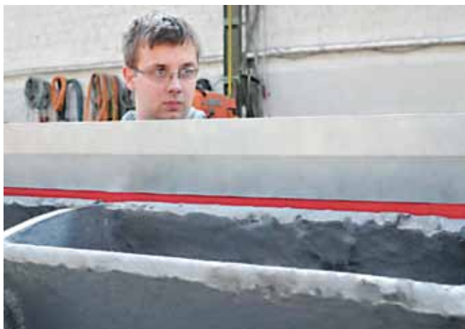
Siemens-Elmo -mallisen alipainepumpun kulunut roottori hiekkapuhalluksen jälkeen, materiaalin hävikki merkitty punaisella.
