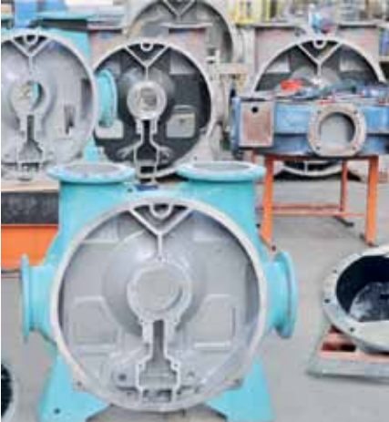
Puhdistettu ja kerrostumilta suojaavilla komposiiteilla pinnoitettu Nash-kartio.
