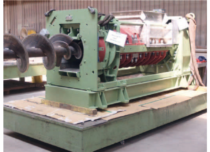
Kufferath Presse A500:n perusparannus ja kunnostus ja sen „erittäin kulumiskestävät“ rakenneosat (sähköosat ja pneumaattikka mukaan luettuina).
