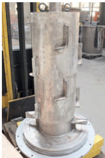
Kulumiskestäväksi kunnostettu rumpuroottori CS12 (ks. kansisivu)
