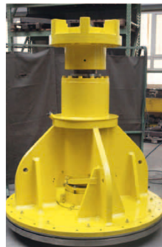
Täysin kunnostettu pulperin laakerointi Escher Wyss ST11
