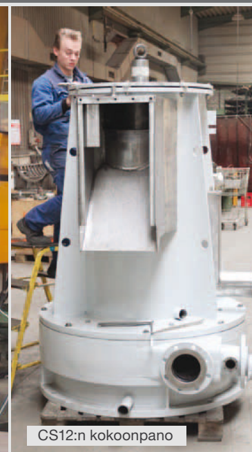
Combisorter CS12:n kulumiskestävän uuden yläkotelon koneistus
