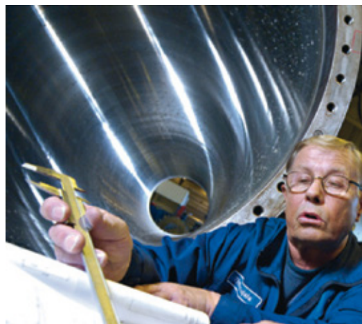
Exemple de service – honage d'une virole Nipco, rugosité de surface Ra = 0,4 μ
