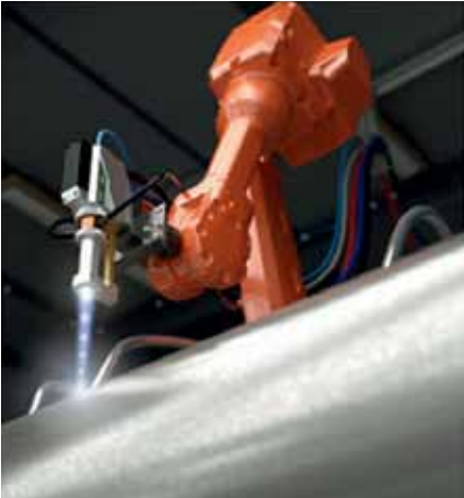
RiWaMat-revêtement en carbure de tungstène d'un rouleau de calandre par technique HVOF
