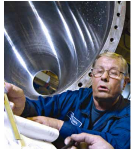
Maintenance avec le revêtement de cylindre de Nipco, rugosité de surface Ra = 0,4 µ
