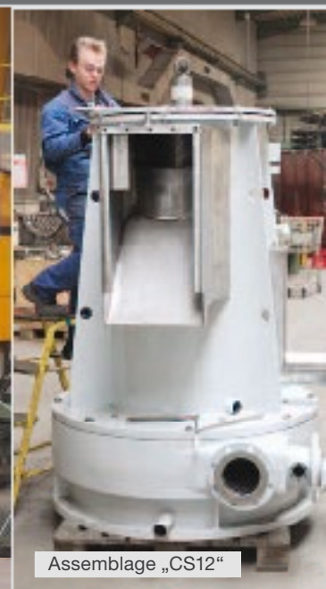
Traitement du nouveau boîtier supérieur résistant à l'usure „Combisorter CS12“
