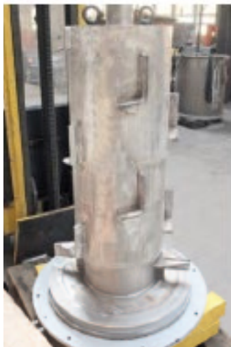
Rotor à tambour CS12 (voir page de titre), traité pour être très résistant à l'usure
