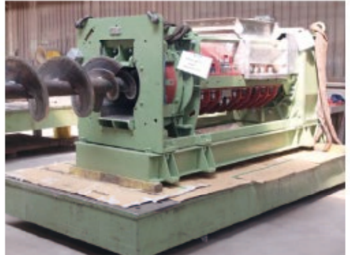
Révision générale d'une presse Beltec BP601 avec la presse BP601 résistante à l'usure avec des composants traités pour être résistants à l'usure
