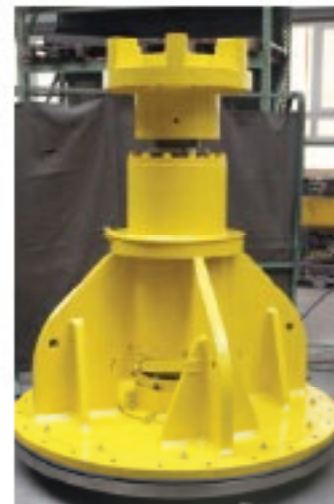
Roulement de pulpeur révisé de manière générale Escher Wyss ST11
