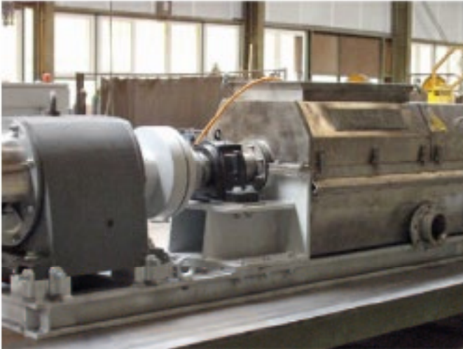
Révision générale de la presse Kufferath A500 avec des composants traités pour être résistants à l'usure (incluant systèmes électrique et pneumatique)
