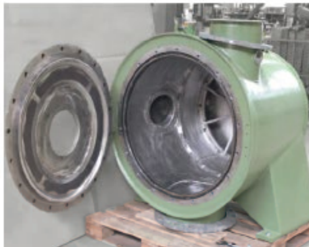
Boîtier F1T pour dispositif de fibrage régénéré traité pour être très résistant à l'usure sur une aléuseuse CNC
