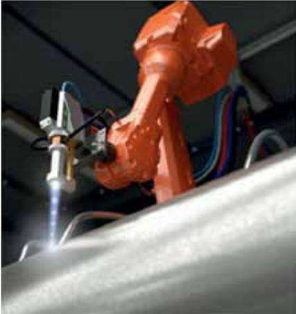
Revestimiento de carburo de wolframio RiWaMat de un rodillo de calandria a través del proceso HVOF
