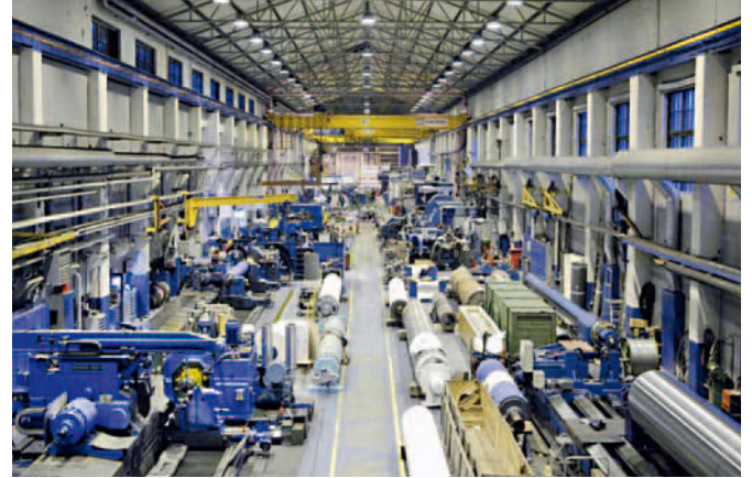
Nave para el procesamiento de rodillos grandes como torneado, lijado, perforación de tubos, bruñido y equilibrado con posibilidades para pesos unitarios hasta 80 toneladas
