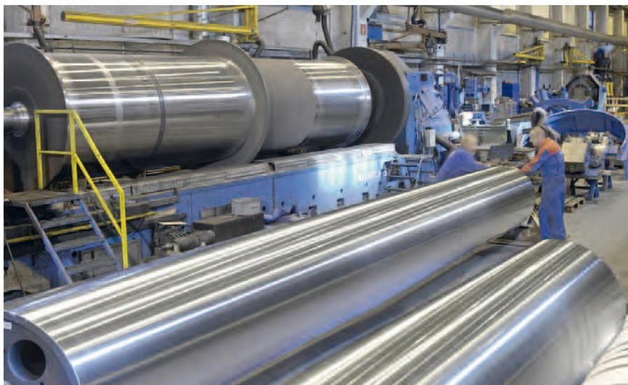
Termería de cilindros grandes en la planta de Karhula en Finlandia para componentes hasta las dimensiones máx. de 2,10 m Ø x 18 m de largo (80 toneladas)
