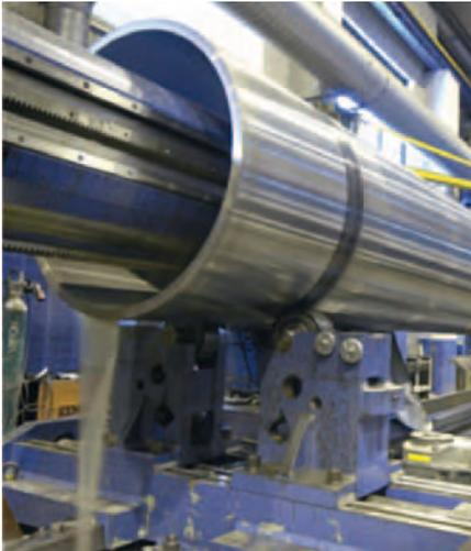
Mandrinado de un tubo para la fabricación de una camisa nueva para un rodillo compensador de flexión
