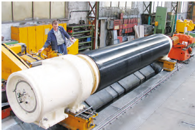
Rectificación de un cilindro aspirador que ha sido revisado a fondo en la planta II rolls
