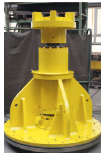
Cojinete de pulpa Escher Wyss ST11ST11 reacondicionado
