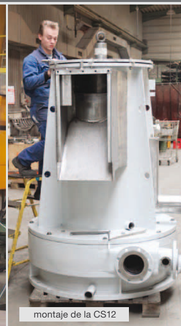
trabajos en la parte superior nueva de la caja "resistente al desgaste" de una Combisorter CS12
